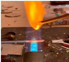
Da geschmolzenes Glas wie semiflüssig wird, wird der Perlendorn, sobald das Glas aufgetragen wurde, bis zum Ende der Arbeit kontinuierlich gedreht. Wenn dies nicht getan werden würde, gäbe es „unrunde“ Perlen. Manchmal ist auch genau das gewünscht!
